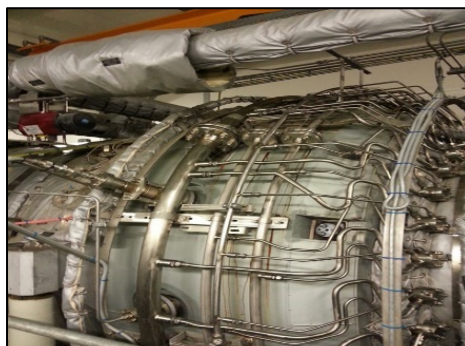
ภาพที่ 2.3-2 Dry Low NO x Combustor
